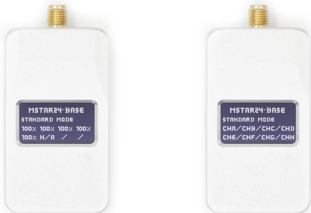
Das Display des Bodenmoduls: Signalstärke der Kanäle und die Kanalzuordnung ChA-ChH
