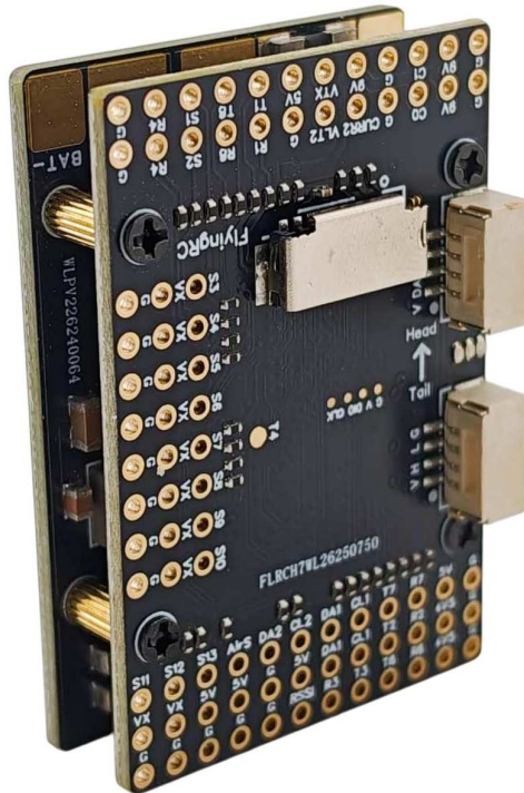
Baugruppe aus Flugsteuerung und Stromverteilerplatine
