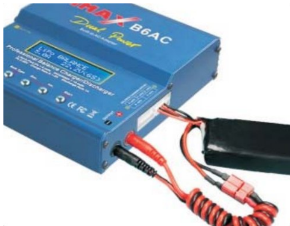
Richtiger Anschluss des Akkus zum Balance-Laden
