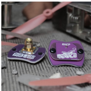
Rückseite mit SMA-Anschluss und Vorderseite der Antenne
