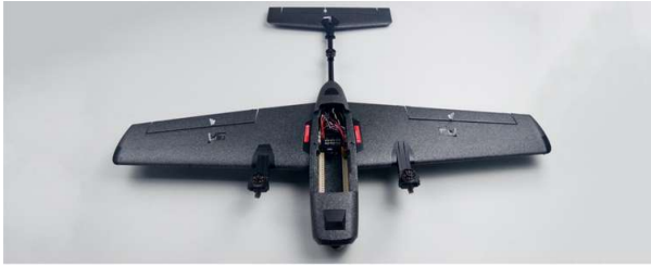
Ruderhörner und Gestänge sind montiert
