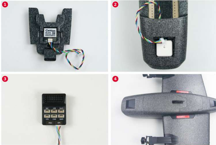
Montage des GPS-Moduls ① bis ④
