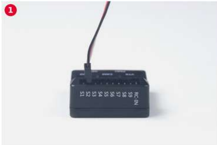
① Anschluss an Ausgang S2 · ② Anschluss des Drehzahlreglers
