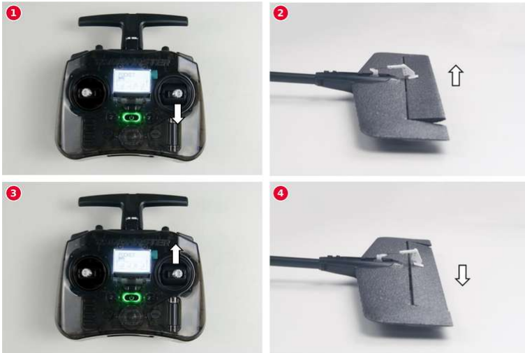
Prüfung des Höhenruders ① bis ④
