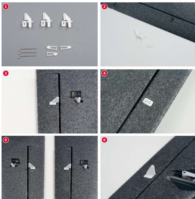
Montage der Ruderhörner ① bis ⑥
