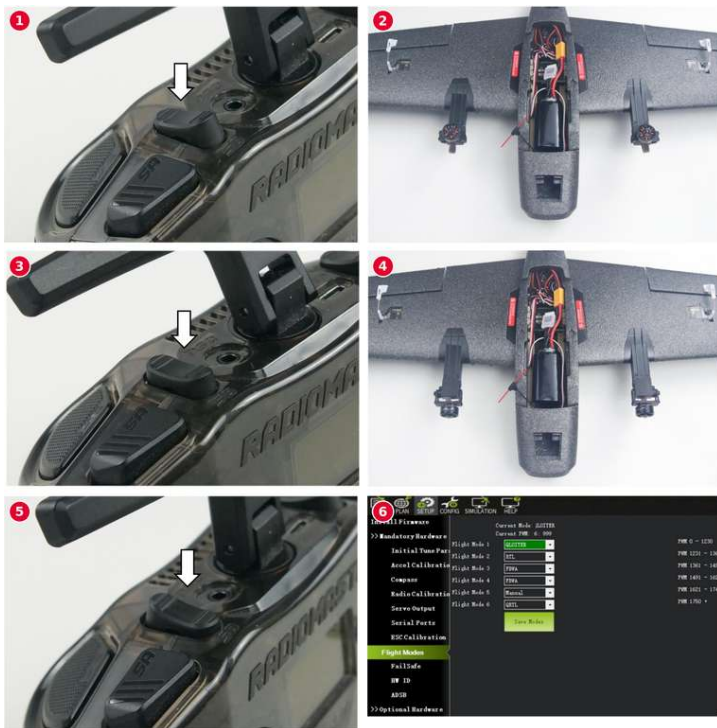
Stellung 1 ① und ②, Stellung 2 ③ und ④, Stellung 3 ⑤, Einstellung der Modi ⑥
