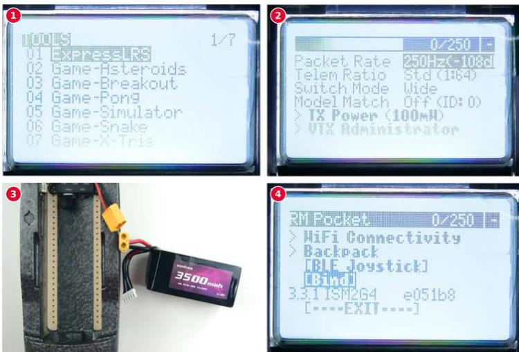
Schritte ① bis ④ beim Binden des ExpressLRS-Empfängers
