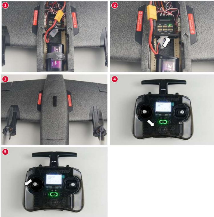
Einschalten ① bis ③, Arm ④ und Disarm ⑤
