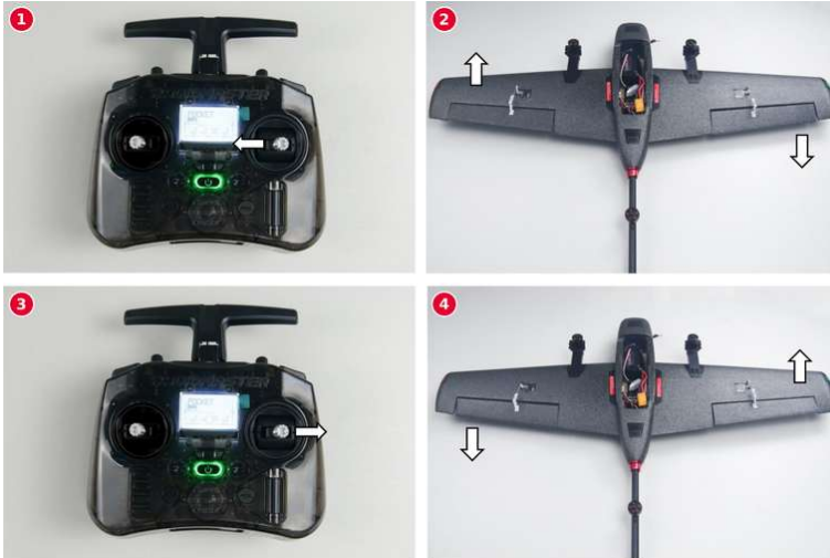
Prüfung der Querruder ① bis ④
