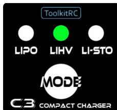
Ladegerät eingeschaltet, Typ LIHV gewählt
