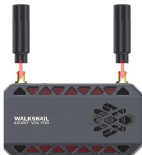
Montage der Antennen an den RP-SMA-Anschlüssen
