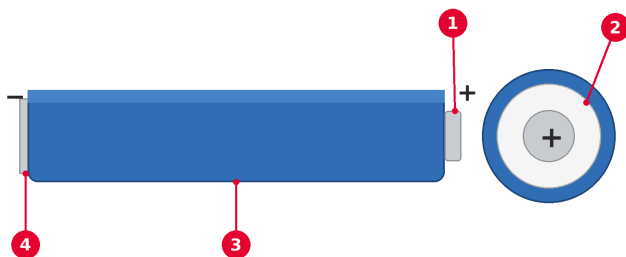
Abb. 1 – Rundzelle: ① Pluspol (+), ② Isolerring, ③ Schrumpfschlauch (Ummantelung), ④ Minuspol (–)
