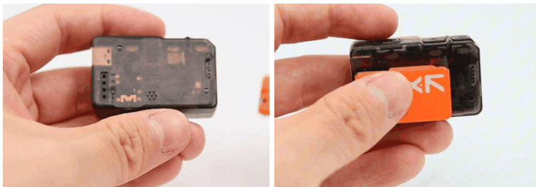
Erweiterungsanschluss des Headtrackers (links) und montiertes Sendemodul (rechts)
