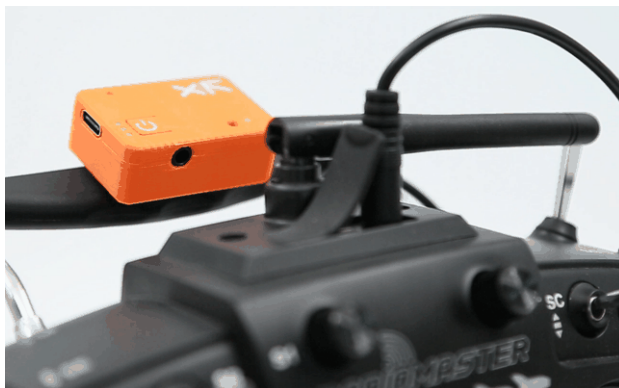
An die Fernsteuerung angeschlossenes Empfängermodul
