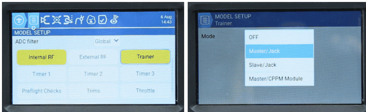
Punkt Trainer auf der Seite MODEL SETUP und Auswahl des Modus Master/Jack
