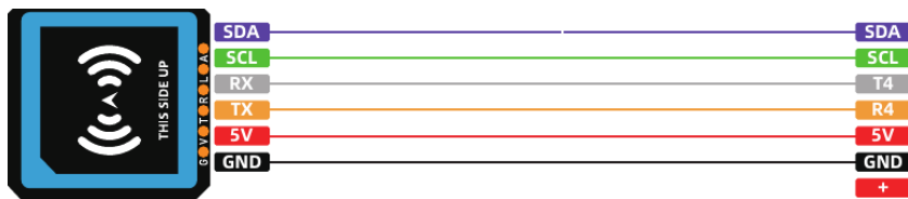
Anschluss eines GPS-Moduls mit Kompass
