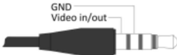
AV connector wiring (3.5 mm jack)
