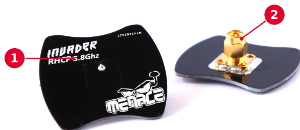
① Vorderseite mit Polarisationsangabe ② SMA-Anschluss auf der Rückseite
