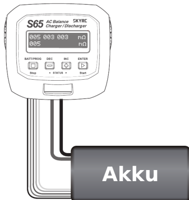
Richtiger Anschluss des Akkus zur Widerstandsmessung
