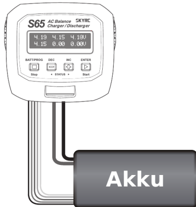
Richtiger Anschluss des Akkus zur Spannungsmessung
