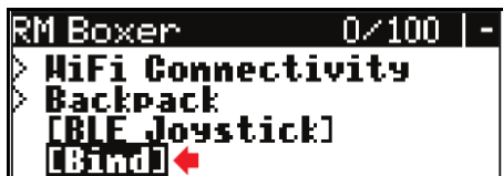
Abb. 2 – Schaltfläche [Bind] im ExpressLRS-LUA-Skript
